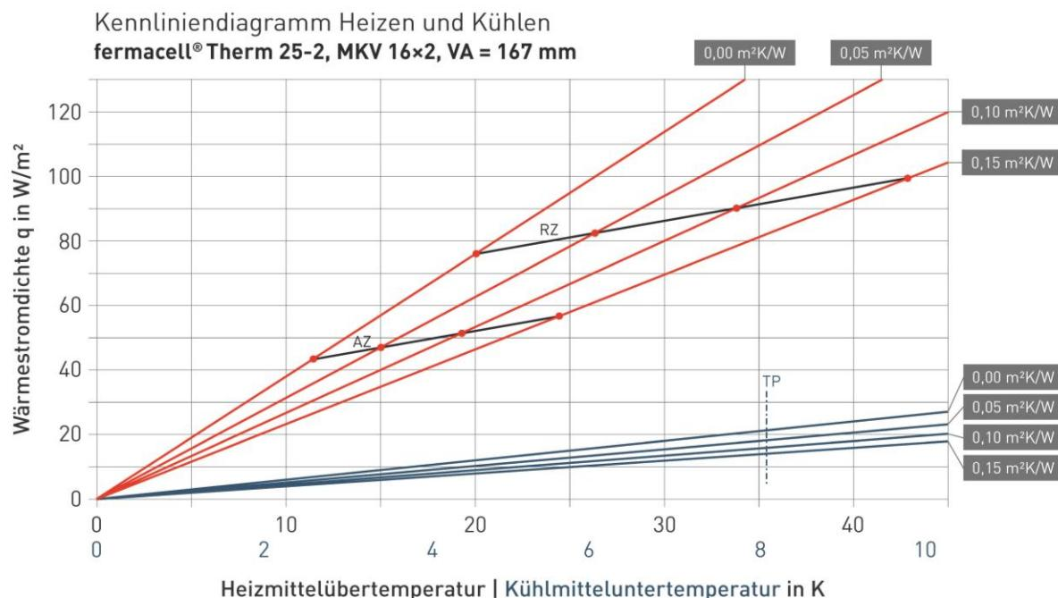
0,00  $\text{m}^2\text{K}/\text{W}$  (npr. pločica) / 0,05  $\text{m}^2\text{K}/\text{W}$  (npr. parket 10 mm) / 0,10  $\text{m}^2\text{K}/\text{W}$  (npr. parket 15 mm) / 0,15  $\text{m}^2\text{K}/\text{W}$  (npr. debeli parket, tepih)
