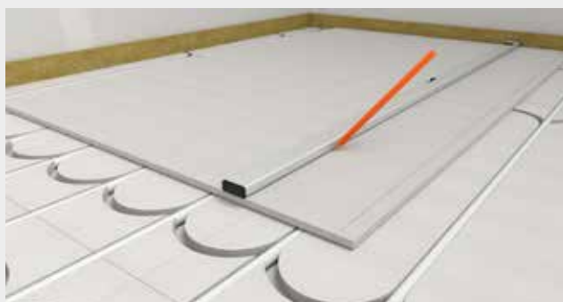
Označite točke pričvršćivanja i osi. Označite točke pričvršćivanja.
