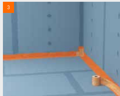
3 Utisnite fermacell™ traku za brtvljenje u vlažnu tekuću foliju.
