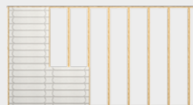
Ugradnja Therm25 u podkonstrukciju (vijci 40mm ili konole 50mm)
