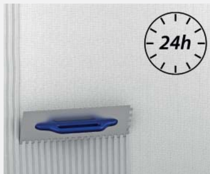
Nanošenje drugog sloja žbuke s 2-3 mm fermacell™ HD laganog morta nakon otvrdnuća armaturnog sloja
