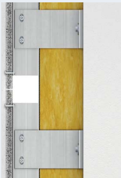
Varijanta 1: Spoj profila ploče
