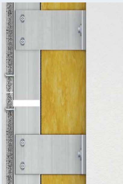
Varijanta 2: Prekriveni spoj ploče
