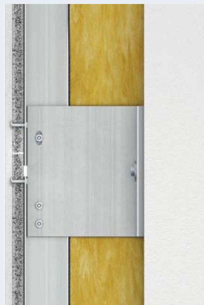
Varijanta 3: Spoj profila prekriven kombinacijom spoja na zidni držač
