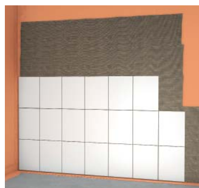
Prikaz 9: Polaganje pločica s fermacell™ Flex ljeplom u postupku tankog sloja na brtvu preko cijele površine (osiguranje brtvljenja za klasu djelovanja vodom W2-I)
