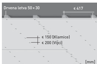
Stropna konstrukcija otporna na udarce loptom s drvenim letvama, izravno pričvršćeno
