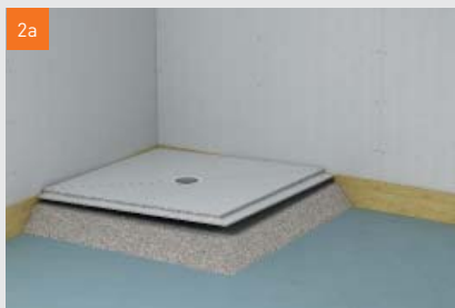
Varijanta A: u visini gornjeg ruba kućišta za odvod, u području elementa tuša nanosi se vezni nasip i smješta se element za tuš.
