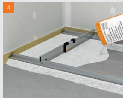
fermacell™ nanošenje nasipa za izjednačavanje
