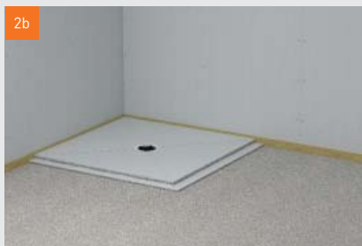
Varijanta B: Povlačenje u visini gornjeg ruba kućišta odvoda preko cijele površine pomoću veznog sredstva i smještanje elementa za tuš
