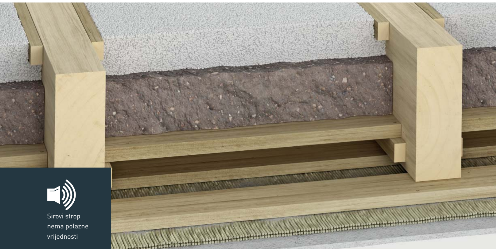
Zatvoreni strop od drvenih greda, nosivi potisak
