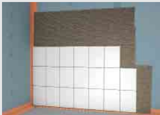
Prikaz 5: Osiguranje brtvljenja za klasu djelovanja vodom W0-I popločavanje s fermacell™ flex ljepljivom u postupku tankog sloja.
