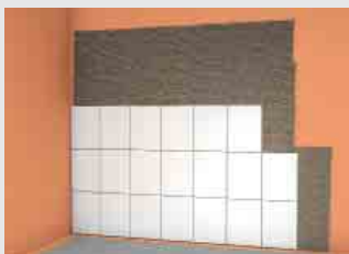
Prikaz 8 : stavljanje pločica s fermacell™ Flex ljepljivom u postupku tankog sloja na brtvljenje cijele površine
