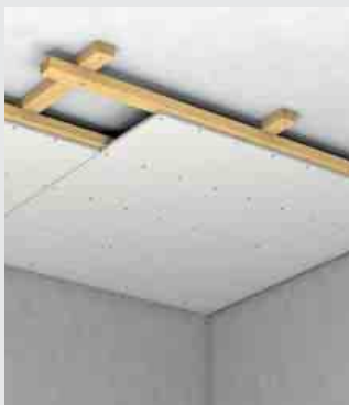
Izravno pričvršćeni strop s drvenom potkonstrukcijom
