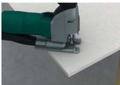
Piljenje s električnom ubodnom pilom
