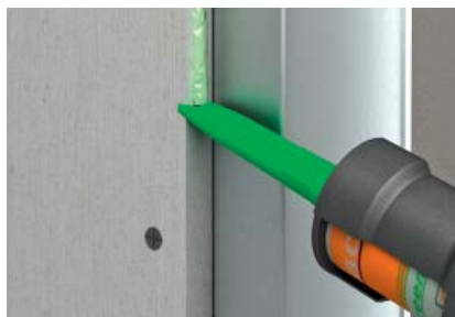
Nanijeti 310 ml kartušu na rub ploče. Specijalni rub ploče osigurava točnu količinu ljepila kod 10 i 12,5 mm ploče. Kod 15 i 18 mm ploče potrebno je odrezati rub.
