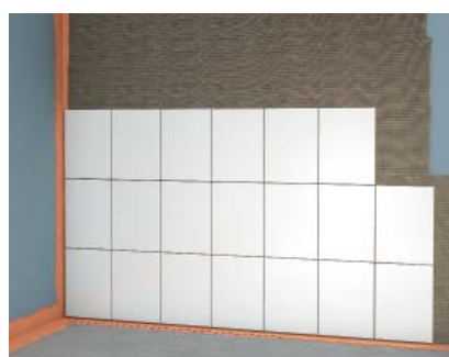
Slika 6: Osiguranje brtvljenja za klasu djelovanja vodom W0-I. Popločenje s fermacell™ flex ljepljivom u postupku tankog sloja
